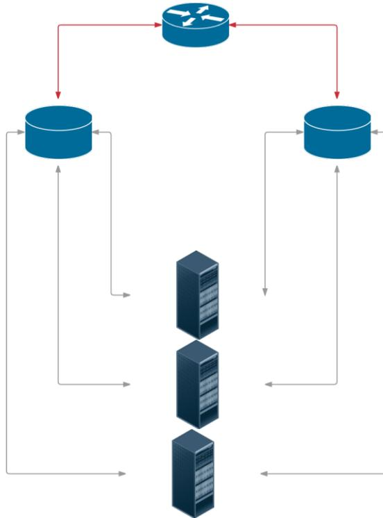
Como podemos ver tenemos 1 router, que se conecta a dos switches y de estos se conectan a los servidores, así creando redundancia en la conectividad de los servidores. Como podemos identificar tenemos un punto de fallo, este punto se hablará en las mejoras de la red más adelante. La conexión de estos equipos es muy simple, se debe de etiquetar todo el cableado como en la siguiente imagen y dejar la red física lo más organizada posible:
