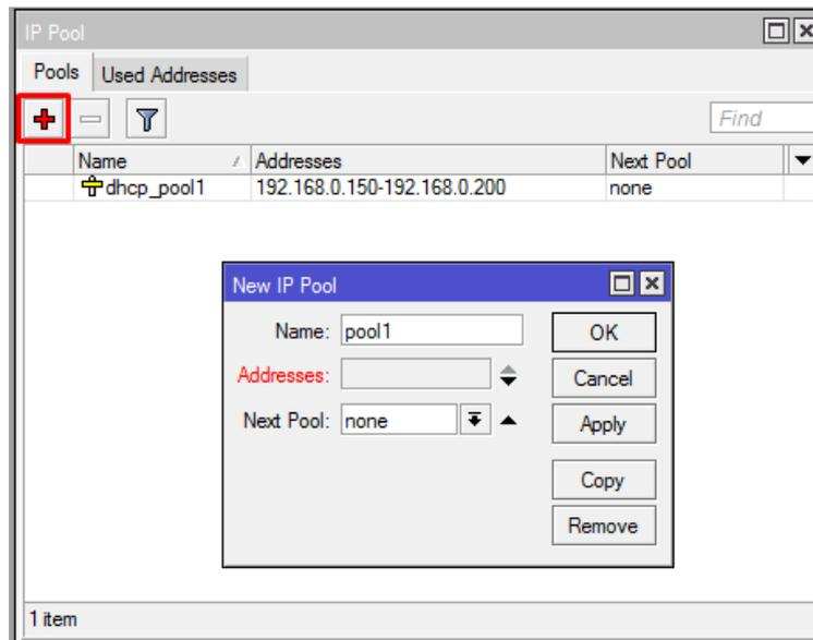
Una vez configurado quedará de la siguiente manera, se ha configurado para que reciba 9 conexiones simultáneas:
