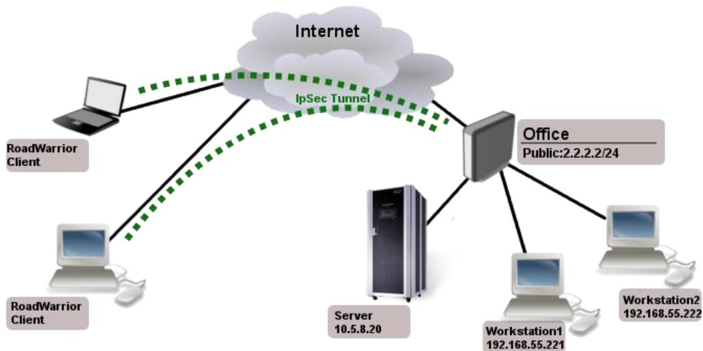
El primer paso para poder configurar una VPN road warrior es crear un pool de direcciones para las conexiones entrantes, para esto nos iremos a:
