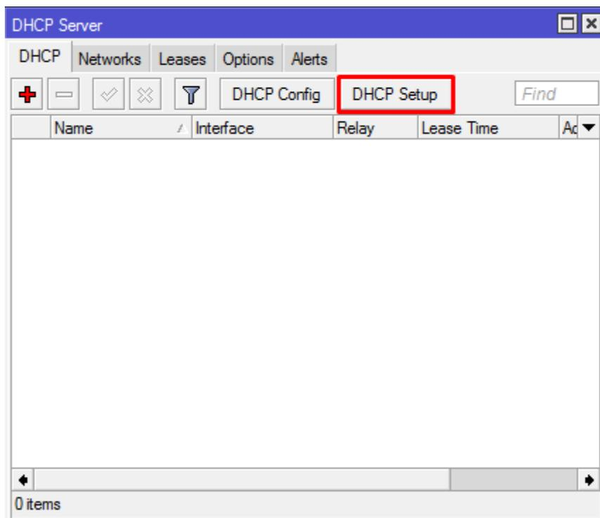
Una vez pulsado en DHCP Setup, se nos abrirá un asistente de configuración para configurar nuestro DHCP:
